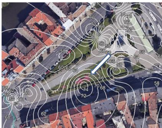
Fig.3.5. Pentru măsurătorile din Piața Mihai Viteazu din data de 10.09. 2022 efectuate prin metoda grilei se observă o scădere rapidă a valorilor SPL exprimate în L_{Aeq} (areal indicat prin săgeată) datorate absorbției ridicate a suprafeței ierboase. (realizare personală).
