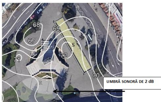
Fig. 3.5 Umbra sonoră produsă de complexul statuar Mihai Viteazu de cca 2 dB având ca sursă fântâna arteziană (S) având un nivel de 72 dB cu o poziție a receptorului în punctul virtual (R), unde se resimt 70 dB. Detaliul face parte din harta izofonelor realizată pe grila de măsurare din data de 15.08.2022 (realizare persoanlă).
