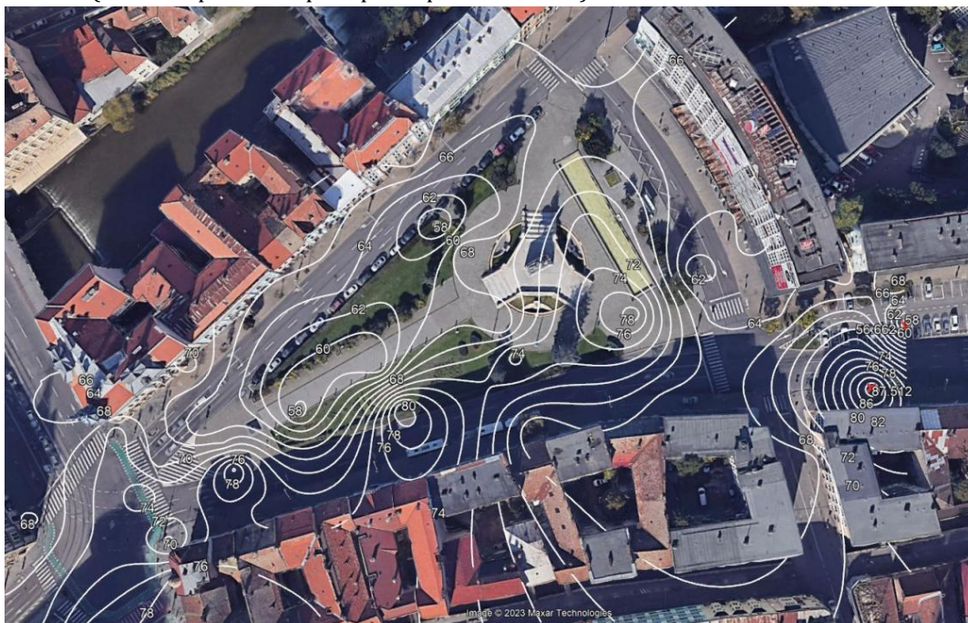
Fig. 3.4.Harta în izofone realizată pentru valori maxime pe baza măsurătorilor din data de 12.07.2022 din intervalul orar 10.20-12,13 la 1,10m (realizare personală pe suport Google Earth, accesat în dat de 14.08 2023).
